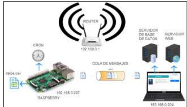
Figura 4. Diagrama del envío de datos del Raspberry a Ubuntu Server.
